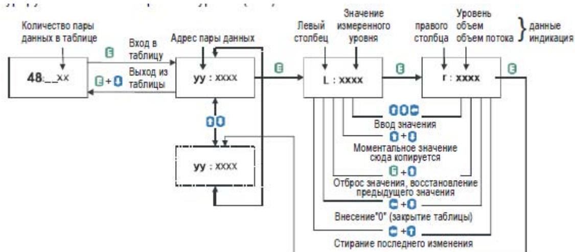
После введения пар данных, прибор расставит их в порядке возрастания. Если в порядке расстановки данных произойдет ошибка, то прибор отобразит это на экране модуля.
