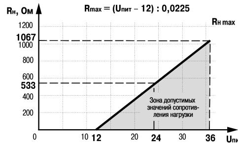
Рисунок 2.1 – График для выбора допустимых значений сопротивления нагрузки
