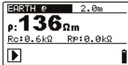
Рисунок 5.10: Пример результатов измерения удельного сопротивления грунта.
