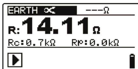
Рисунок 5.6: Пример результатов селективного измерения сопротивления заземления
