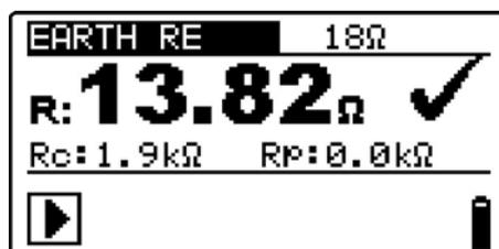
Рисунок 5.4: Пример результата измерения сопротивления заземления
