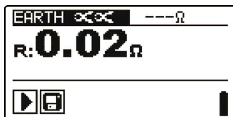
Рисунок 5.8: Пример результатов измерения сопротивления заземления с помощью 2 клещей.
